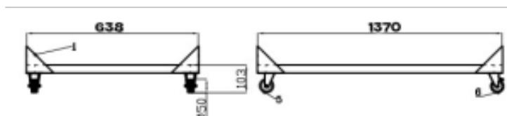
Le Support pour Saladette à 3 Portes optimise l'espace et l'efficacité dans les cuisines professionnelles. Conçu avec une structure légère (poids de 0 kg) et mobile grâce à quatre roues (dont deux avec frein), il garantit une facilité de déplacement et de sécurisation. Ses dimensions sont de 1370 mm en largeur, 638 mm en profondeur et 103 mm en hauteur, s'adaptant ainsi parfaitement à divers environnements. Ce support allie praticité et durabilité pour les professionnels exigeants.
