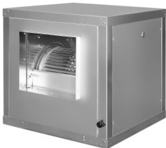
Le Ventilateur Caisson 12/12 - 4500 m<sup>3</sup> se distingue par sa capacité à renouveler efficacement l'air avec un débit de 4500 m<sup>3</sup>/h, assurant ainsi un environnement de travail optimal dans les cuisines professionnelles. Sa taille compacte (620 x 675 x 640 mm) et son poids de 30 kg garantissent une installation aisée et une utilisation durable. Fonctionnant à 230 V pour une puissance de 736 W, ce modèle de Chaysol combine efficacité énergétique et performance haut de gamme.
