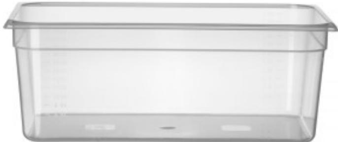
Ce **Bac Gastronorme GN 1/1 Gradué** est réalisé en polypropylène. Sa profondeur est de 200 mm et sa capacité de 28 L. Il s'utilise avec des températures allant de -40°C à 80°C.
