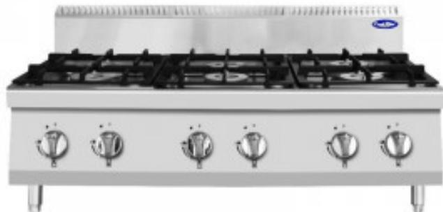
Ce **Fourneau à Gaz à Poser** pourvu de 6 Brûleurs de puissance 6 x 7 kW est un équipement de cuisson pour toute cuisine professionnelle avec sécurité thermocouple, allumage manuel et grilles amovibles en fonte émaillée. Il est compatible avec du gaz naturel ou du propane et mesure L 1200 x P 700 x H 597 mm.
