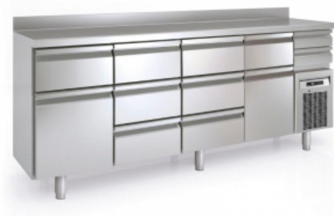
Cet **Arrière-Bar Réfrigéré** d'une capacité de 684 L est idéal pour les professionnels. Conçu en acier inox 18/10, il est solide et résistant. Sa plage de température est comprise entre - 2 °C et + 8 °C. Il comprend 2 tiroirs de 2 x 300 mm de profondeur, 6 tiroirs de 3 x 165 mm de profondeur et 2 tiroirs de 1 x 190 mm et 1 x 300 mm de profondeur.
