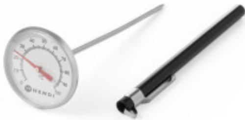
Ce **Thermomètre de Poche** est doté d'une plage de température comprise entre 0 °C et + 100 °C. Sa graduation est de 1°C. Il mesure la température en °C. Il dispose d'une sonde en acier inoxydable et d'une protection avec clip pour la sonde.
